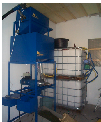
Stor unit påmonteret Rensesmaskine
