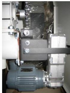
Schweizisk lav-friktions tandhjulsgeard med lavt energiforbrug
